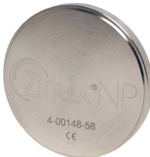
Zirlux NP ist eine nickel-, berylliumfreie Kobalt-Chrom-Legierung zum Anfertigen von Zahnersatz. Sie lässt sich leicht fräsen und ist geeignet für alle Fräsanlagen welche für endfestes NEM geeignet sind.
